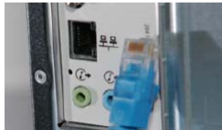
Nätverkskortets uttag och nätverkskabel kontakt RJ45
